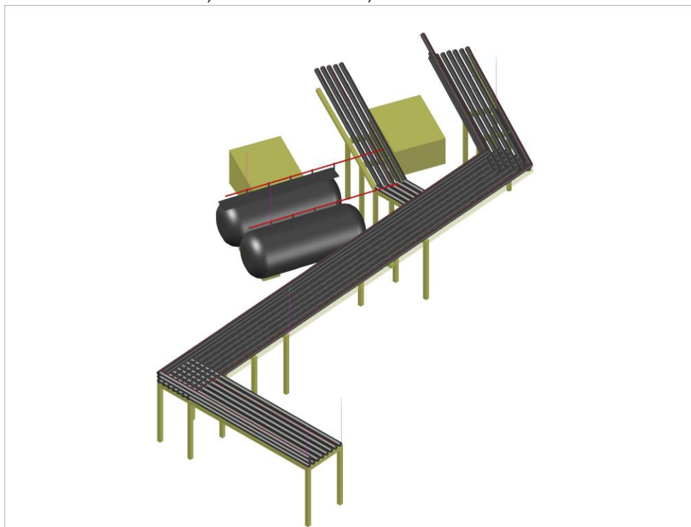
Slika 20: 3D izris objektov REZERVOARJA BIODIZLA, SKID ZA ADITIVE, ČRPALIŠČE BIODIZLA z vrisano strelovodno instalacijo
